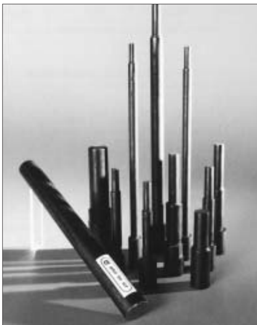
Core pins in Uddeholm QRO 90 HT (prehardened Uddeholm QRO 90 Supreme)
